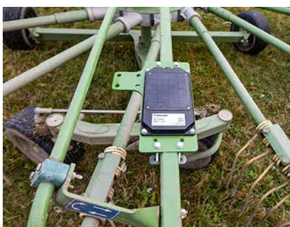
Am Zweikreiselschwader lies sich der Datenlogger gut an einem Vierkantrrohr befestigen. Fotos: Holzhammer
