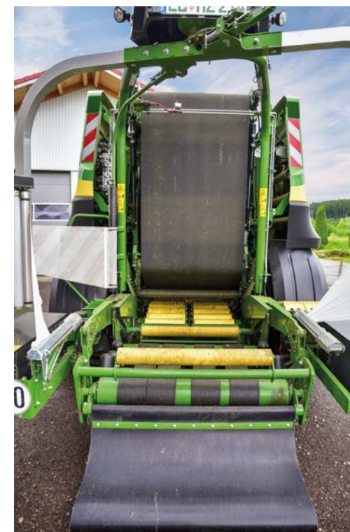
Durch das Monoriemen-Konzept bei der neuen Krone CombiPack HDP können Bröckelverluste fast vollständig vermieden werden.
