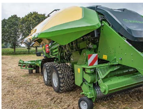
15 bis zu 15 kg schwere Garnrollen passen in jeden Garnkasten, der „auf Augenhöhe“ beladen werden kann. Und zum Reinigen dahinter lässt er sich aufklappen – alles auf Knopfdruck!
