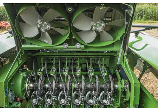
Die leistungsfähigen Gebläse halten die sechs Doppelknoter sauber. Die neuen V-Knoter (Kasten) sind künftig „Schnipsel-frei“.
