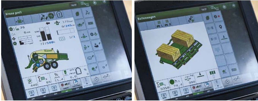
Die Bedienung ist übersichtlich und erfolgt per ISO-Bus. Entweder wie hier über den Schlepper-Bildschirm oder über die verschiedenen Terminals, vom DS 500 bis zum CCI 1200.
