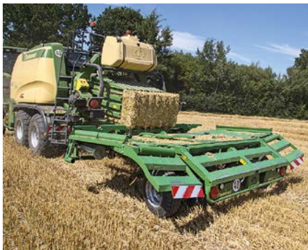
Auf dem Acker wird er starr an den Kanal gezogen und die Räder sind frei drehbar.
