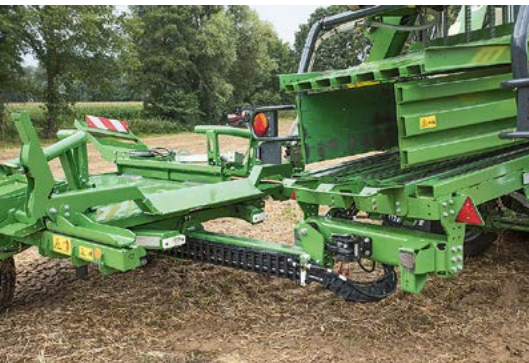
Auf der Straße ist die Deichsel lang, der Sammler folgt wie ein Anhänger.
