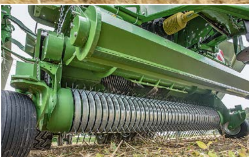
Die ungesteuerte Pickup mit angetriebener Zuführwalze überzeugte. Genau wie die hydraulische Reversierung für den Rotor.
