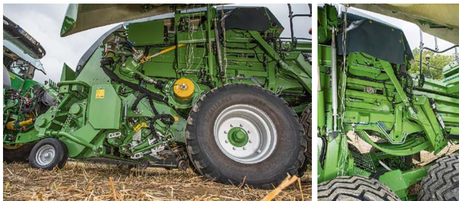
Nur an der Pickup gibt es eine Kette, alles andere sind Direktantriebe. Und auch der Raffer hat jetzt eine Drehmomentmessung.
