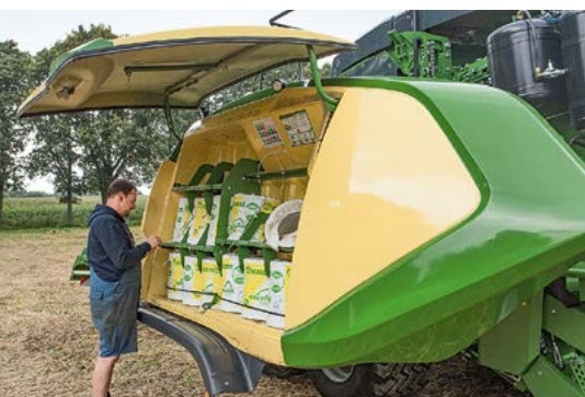
15 bis zu 15 kg schwere Garnrollen passen in jeden Garnkasten, der „auf Augenhöhe“ beladen werden kann. Und zum Reinigen dahinter lässt er sich aufklappen – alles auf Knopfdruck!
