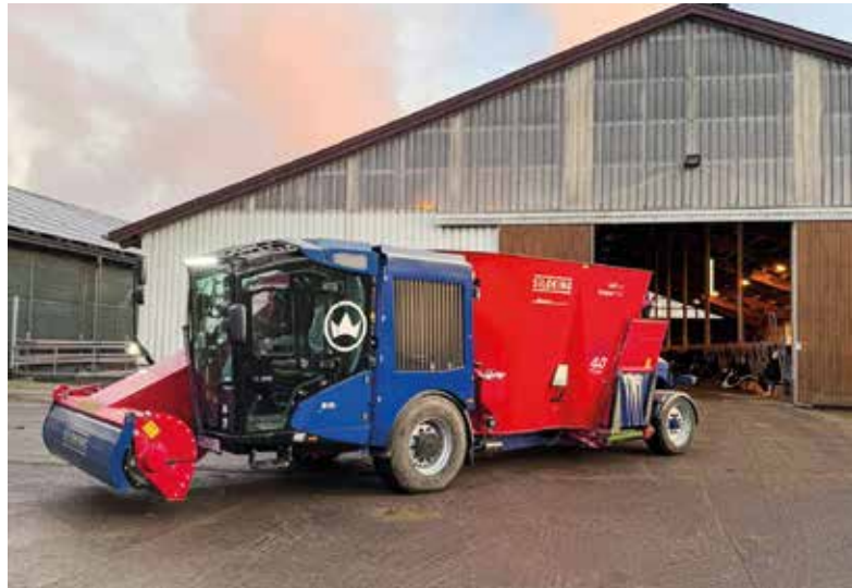
Auch der neue Siloking Futtermischwagen arbeitet mit Sensorik, die hilft, den gewünschten TS-Gehalt in der Ration bereitzustellen.
