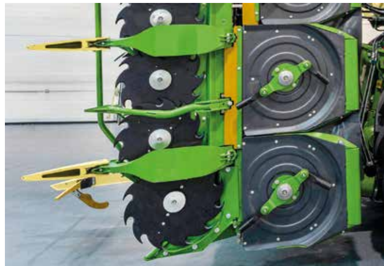
Die Schlegel des Mulchsystems sind so angeordnet, dass sie die Stoppeln unmittelbar nach dem Abschneiden zerkleinern.
