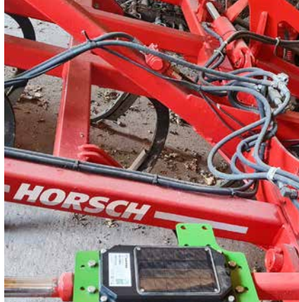
Hier ist ein Krone-Logger auf einem Horsch-Grubber mit der universellen Montageplatte aufgebaut.
