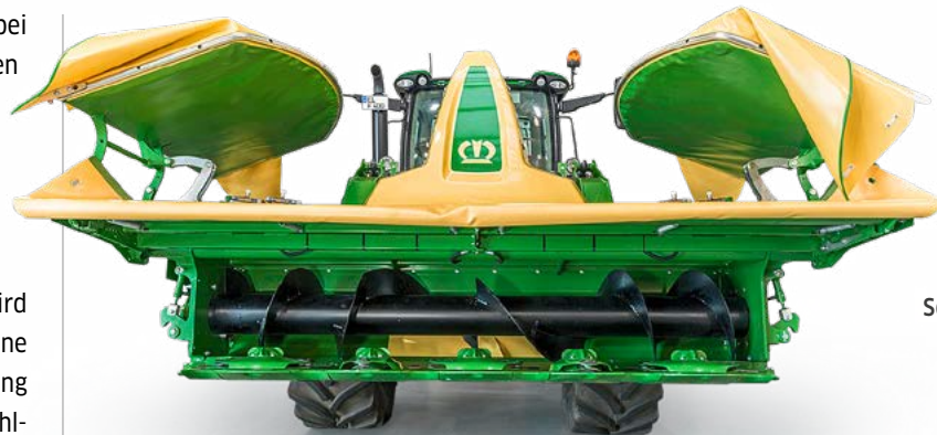
Über den Zahnkranz werden die Seitenelemente durch einen Ölmotor geschwenkt.
