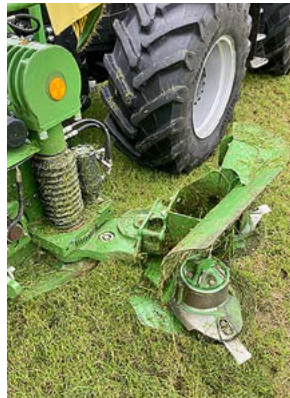
Über den Zahnkranz werden die Seitenelemente durch einen Ölmotor geschwenkt.
