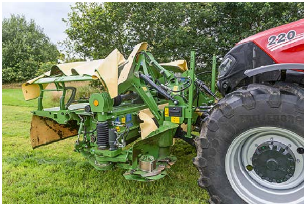
Die beiden äußeren Mähscheiben schwenken hydraulisch nach hinten, die Schutztücher automatisch nach oben.
