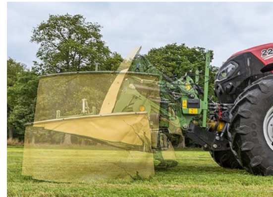
Zum Ausheben bzw. Einsetzen mit der integrierten Aushubkinematik wird ein einfachwirkendes Steuergerät benötigt.
