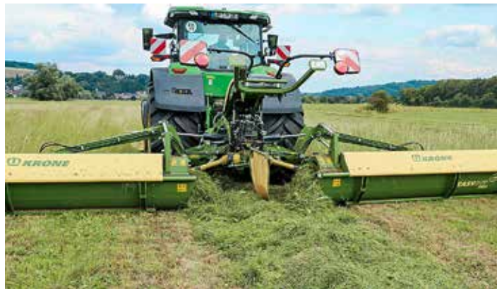
Ein Schwadttuch bietet Krone ebenfalls an. Das Anheben des Leuchtenträgers bringt mehr Durchgang für die Arbeit in massereichen Beständen.
