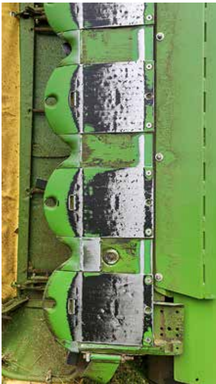
Gehärtete Gleitkufen sind Serie, optional gibt es Kombikufen.
