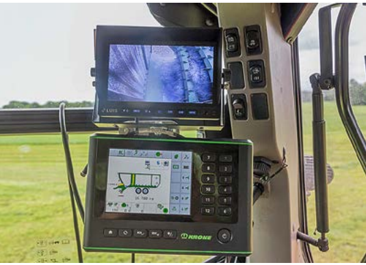
Über das Terminal des Ladewagens zeigt das aktuelle Gesamtgewicht an.
