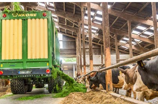
Das Futter wird auf die morgens vorgelegte TMR per Querförderband ausgetragen.
